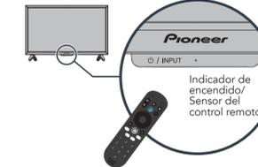
Indicador de encendido/Sensor del control remoto
